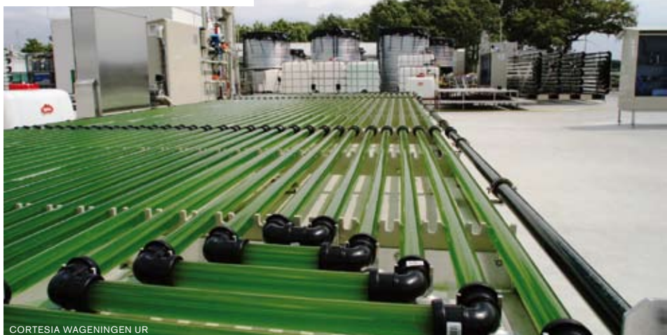
👉 Sistema di coltivazione di microalghe in tubi orizzontali al centro di ricerca AlgaePARC dell'Università di Wageningen, nei Paesi Bassi ( www.algae.wur.nl/UK ).
