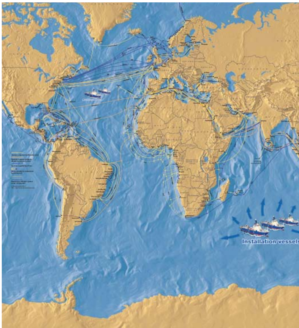
📍 Mappa mondiale della distribuzione sottomarina dei sistemi di fibre ottiche per telecomunicazioni.
